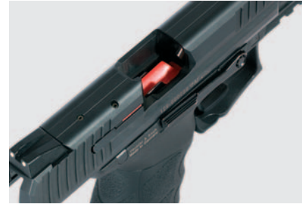
Abb. 7: Der Magazinzubringer kann optional ebenfalls farbig gestaltet werden, damit bei der Sicherheitsüberprüfung sofort erkannt wird, dass das Magazin leer ist. Standardmäßig ist der Zubringer schwarz, in der Variante für die Bundeszollverwaltung ist hat der Zubringer die Farbe weiß.
