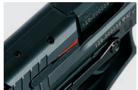
Abb. 6: Als Ausstattungsoption ist ein Ladezustandsanzeiger erhältlich, bei dem oberhalb der Auszieherkralle eine rot markierte „Fahne“ ausschwenkt, sobald sich eine Patrone im Rohr befindet. Somit ist der Ladezustand erheblich besser sichtbar- und fühlbar.
